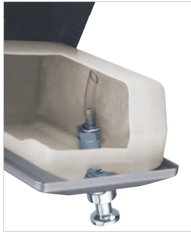
Falsch: Der Behälter kann zur Reinigung nicht entnommen werden und die Seifenpumpe sitzt nicht am tiefsten Punkt. So drohen immer Reste der Seife im Spender zu verbleiben und zu verkeimen.
