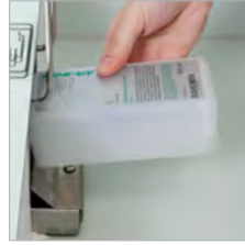
Flaschenwechsel von unten. Halten Sie einen Montageabstand von mindestens 200 mm vom Spender zum Waschtisch ein, damit die Flasche problemlos gewechselt werden kann.
