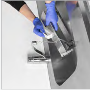
1. Das Gehäuse (inkl. Verschlussschleife) unter fließend heißem Wasser mit einer geeigneten Bürste abspülen, um groben Schmutz und Ablagerungen zu entfernen. Anschließend mit einem Einmalhandtuch abtrocknen.
