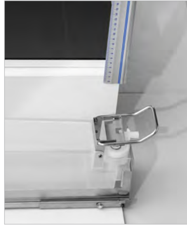
Auch bei Verwendung einer Führungsschiene sollte immer ein Abstand von mindestens 10 mm zwischen Spender und Spiegelfläche (siehe Abbildung unten) eingeplant werden.
